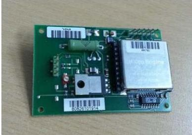
Antenne, Decoder (Micro Engine), Interface RS 232/485, USB, LF oder HF, 5, 12, oder 24 VDC, LEDs, Scheckkartengröße
